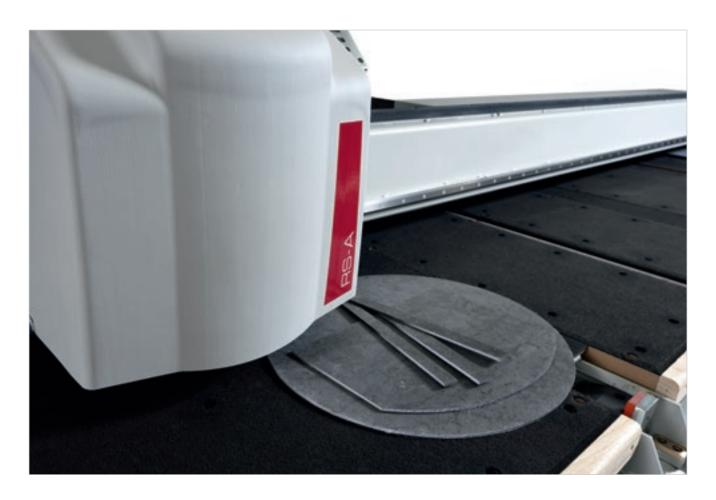
Biesse espande gli orizzonti di taglio ai materiali ceramici di basso spessore con una nuova tecnologia per realizzare tagli di precisione tipici dell'arredamento (rivestimenti per interni,pavimentazioni), piani cucina, edilizia (facciate ventilate,scale, soglie, davanzali).
