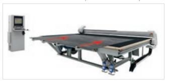
I piedini a scomparsa si riposizionano automaticamente in posizione di sicurezza per inizio taglio. La testa operatrice comincia automaticamente il ciclo di taglio.
